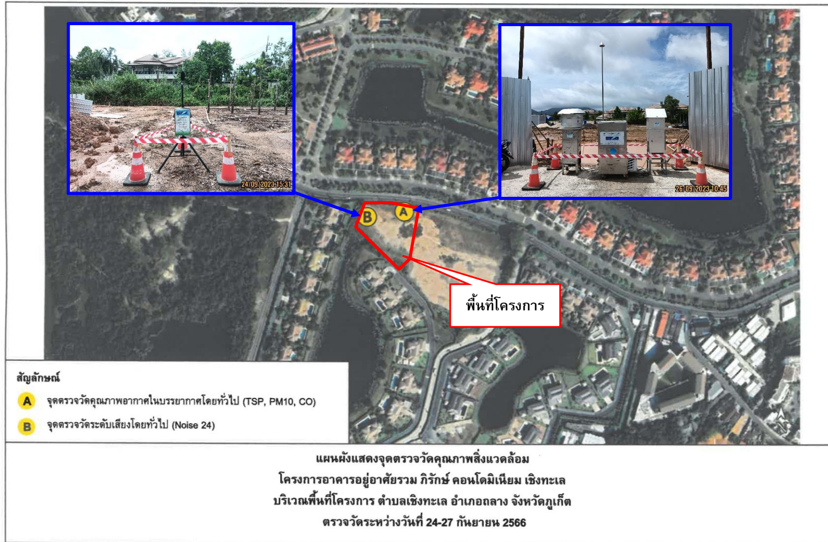
รูปที่ 3-10 จุดติดตั้งเครื่องตรวจวัดคุณภาพอากาศและเสียงภายในพื้นที่โครงการ
